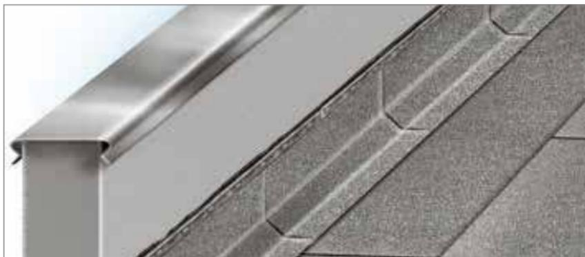
**Общий вид примыкания к высокому парапету:**
