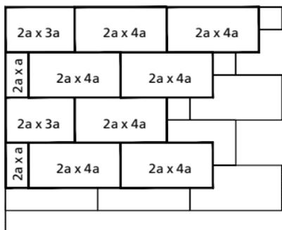
Для упрощения укладки плитного утеплителя в непрямым углах рекомендуется применить следующий способ разрезки плит:
