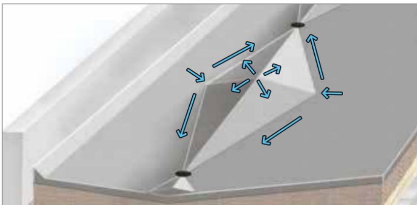
**☰** Уклоны нужны для отвода воды с крыши. Для полного отвода с поверхности кровельного ковра воды по наружным и внутренним водосточкам рекомендуется соблюдать уклон не менее 1,5%. В качестве уклонообразующего слоя могут быть использованы засыпные утеплители (керамзитовый гравий, перлит и прочее), легкие бетонные смеси (пенобетон, керамзитобетон, перлитобетон), цементно-песчаные составы или клиновидные плиты утеплителя.
