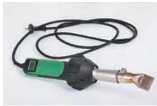
На труднодоступных участках, где невозможно применить автоматическое оборудование, для сварки мембранных применяйте ручные сварочные аппараты моделей «Triac PID» и «Triac S» с комплектом насадок и прижимных роликов.
