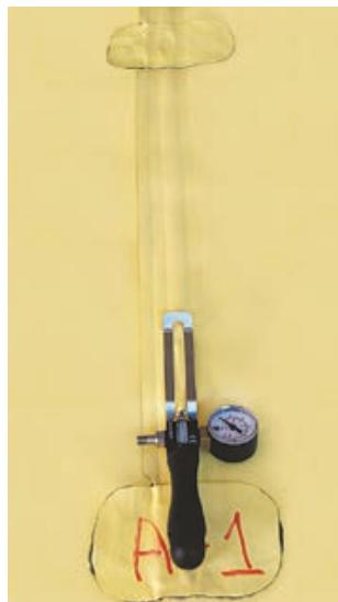
Для проверки герметичности шва введите иглу с манометром в пространство воздушного канала. Для этого слегка разогрейте ручным аппаратом поверхность шва, в которую намечен ввод иглы.
