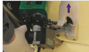
Выньте сопло аппарата из нахлеста, слегка потянув его в сторону по направляющей. Остановите движение ведущих роликов нажатием кнопки «M».
