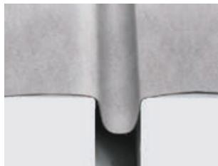
Поверх геотекстиля уложите мембрану **LOGICBASE V-SL** с образованием компенсаторной петли для снижения растягивающих напряжений.
