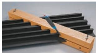
Разожмите кондуктор и вставьте шпонку таким образом, чтобы она немного высосывалась из кондуктора, и снова зажмите.
