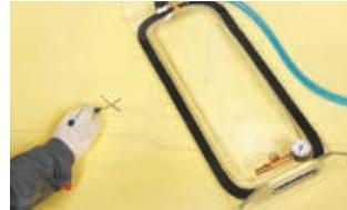
Далее следует произвести проверку на смежном участке шва. Для этого переставьте вакуумный колпак дальше по шву с перекрытием уже проверенного участка на **10–20 мм** и повторите проверку снова. Таким образом следует проверить шов по всей длине.
