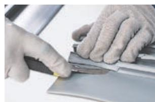
После того как ребра удалены, обязательно скруглите острые углы. Заготовка **2** готова.
