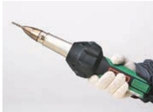
Закрепите щелевую насадку (далее сопло) на трубке нагревательного элемента при помощи винта для фиксации и отвертки. Подробно о выборе насадки см. табл. 2.1.
