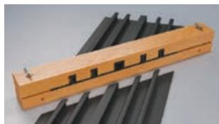
Установите нагревательный элемент в рабочее положение между концами гидрошпонок. Плавно сомкните кондуктор, подводя концы гидрошпонки к нагревательному элементу. При этом вдоль всего периметра среза шпонки образуется валик из расплавленного материала. Следите за тем, чтобы оплавление происходило равномерно.
