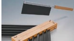
После остывания демонтируйте зажим. Ножом срежьте валик расплавленного материала, образовавшийся по периметру сварного соединения.
