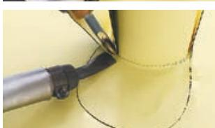
**ВАЖНО!** Используйте латунный ролик для сварки в основании.
