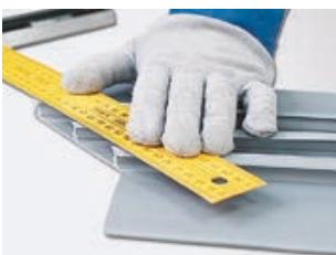
Углы скругляйте с обеих сторон. Это придаст удобство сварке плоских частей и повысит герметичность соединения.
