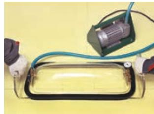
Включив вакуумный компрессор создайте в вакуумной камере разряжение до **2,0 МПа** на протяжении не менее **15 сек.**, после чего отключите компрессор. В некачественно проваренных местах появятся мыльные пузыри.
