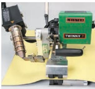
— После полного остывания полученного сварного шва до температуры окружающего воздуха или не ранее чем через **30 минут** после проведения сварки произведите контроль качества.
